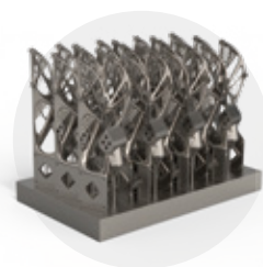
满舱支撑框架
